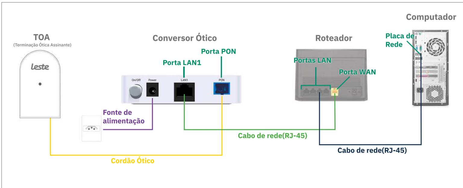
Se o conversor ótico estiver conectado ao seu computador, desconecte a ponta deste cabo e conecte a mesma ponta na Porta WAN do seu roteador.
